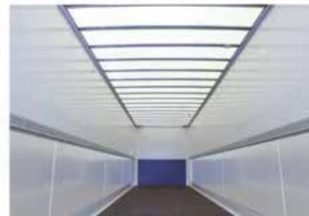
Tetto traslucido fornito di serie. In alternativa può essere montato un tetto opaco termoisolato.
