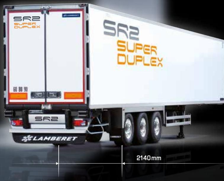
SR2 SUPERDUPLEX offre un carico di 66 pallet su due livelli senza rischio di ribaltamento grazie al telaio SUPERSTABLE (Premio per l'Innovazione Solutrans 2011). Offre un margine di sicurezza supplementare che respinge il limite di ribaltamento del 10% durante le curve.
